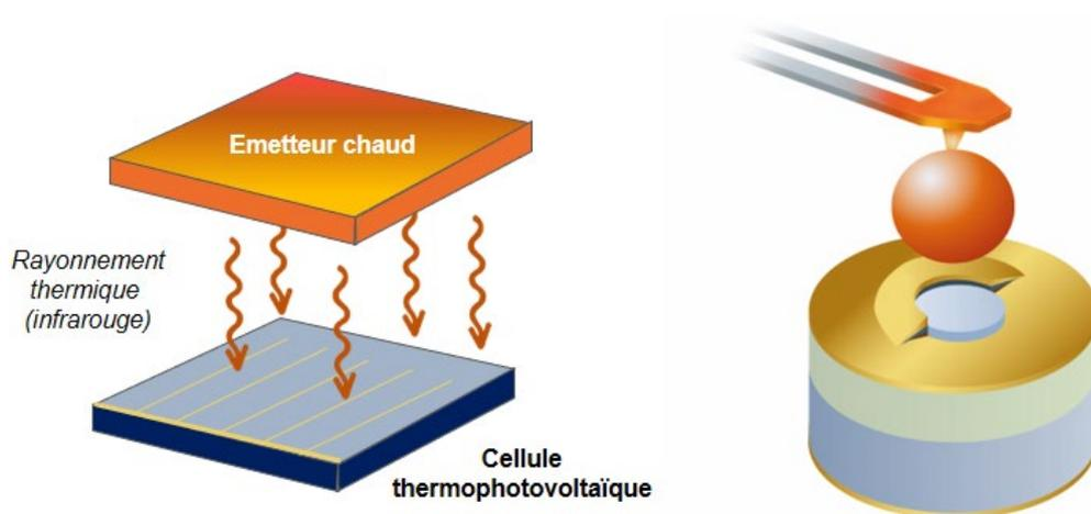
Principe de base de la conversion thermophotovoltaïque (gauche) et son implémentation avec une micro-cellule en champ proche, lorsqu'un émetteur chaud est très proche de la surface de la cellule (droite).
