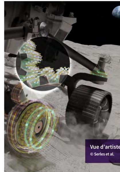
**Un brevet déposé pour un lubrifiant adapté à l'air comme au vide. Du fait des contraintes extrêmes, aucun lubrifiant solide n'était capable de protéger les mécanismes spatiaux sur Terre ET dans l'espace. C'est désormais chose faite.**
